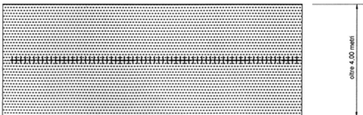
figura 14 scavo al centro della strada
